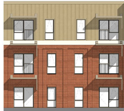
Elevation - Brise Soleil 1 : 100
