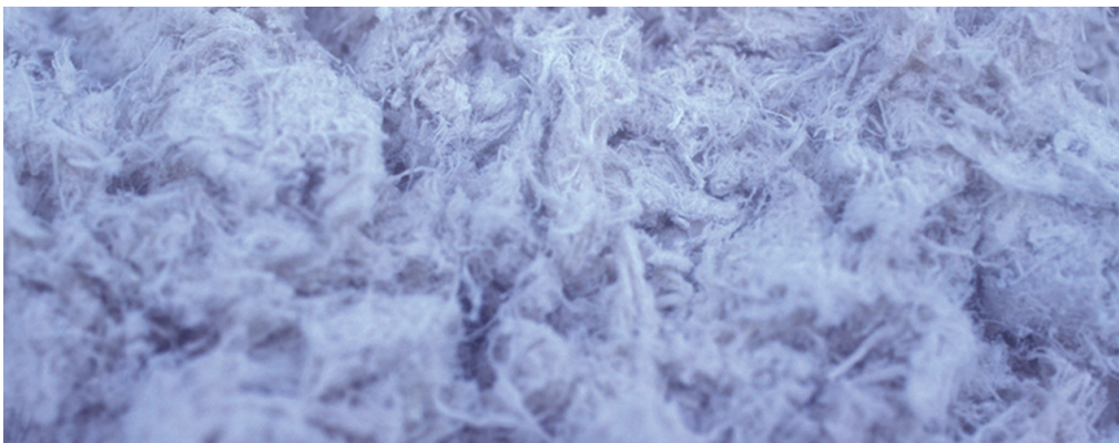
Сыпучий синий асбест из полости в стене
